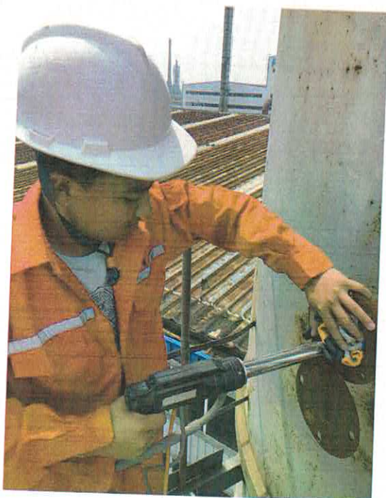
图 3 10000 吨阳离子 PAM 排气筒废气采样
