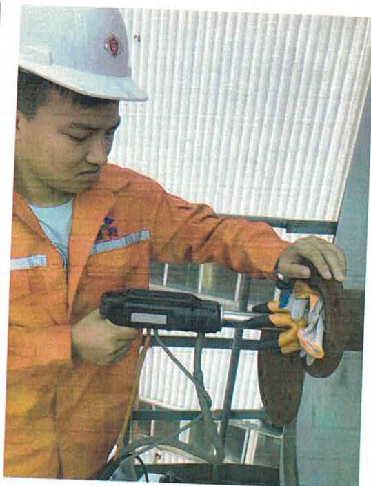
图 410000 吨阴离子 PAM 排气筒废气采样
