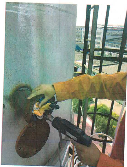
图 5 13000 吨阴离子 PAM 排气筒采样废气采 样
